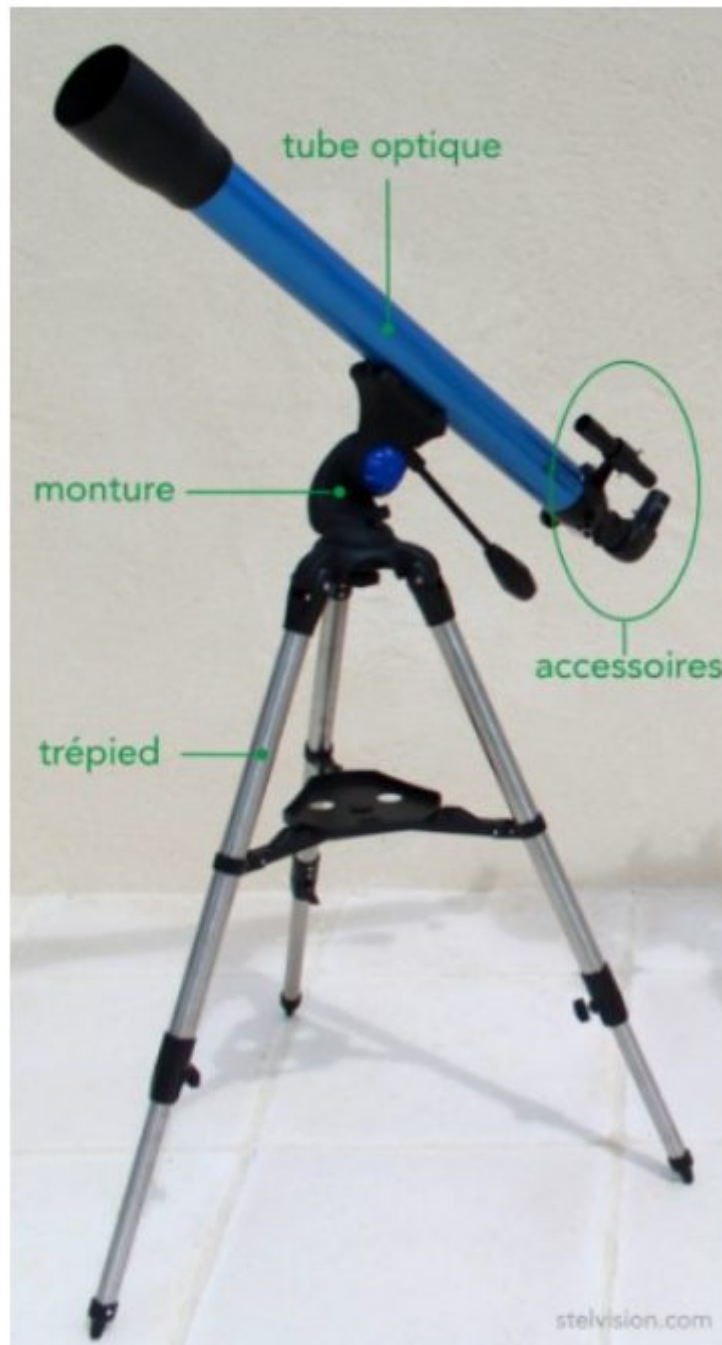
Les constituants d'un instrument d'astronomie. Photo Stelvision.
