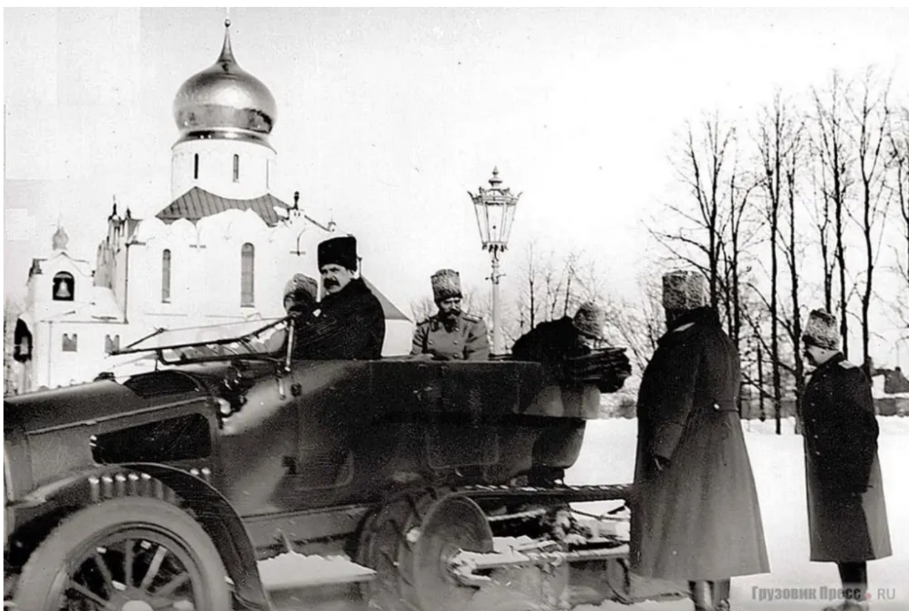
L'empereur Nicolas II (sur le siège arrière), à bord d'un véhicule semi-chenillé Russo-Balt C 24/40. Adolphe Kégresse, l'inventeur, est le conducteur. 1915
