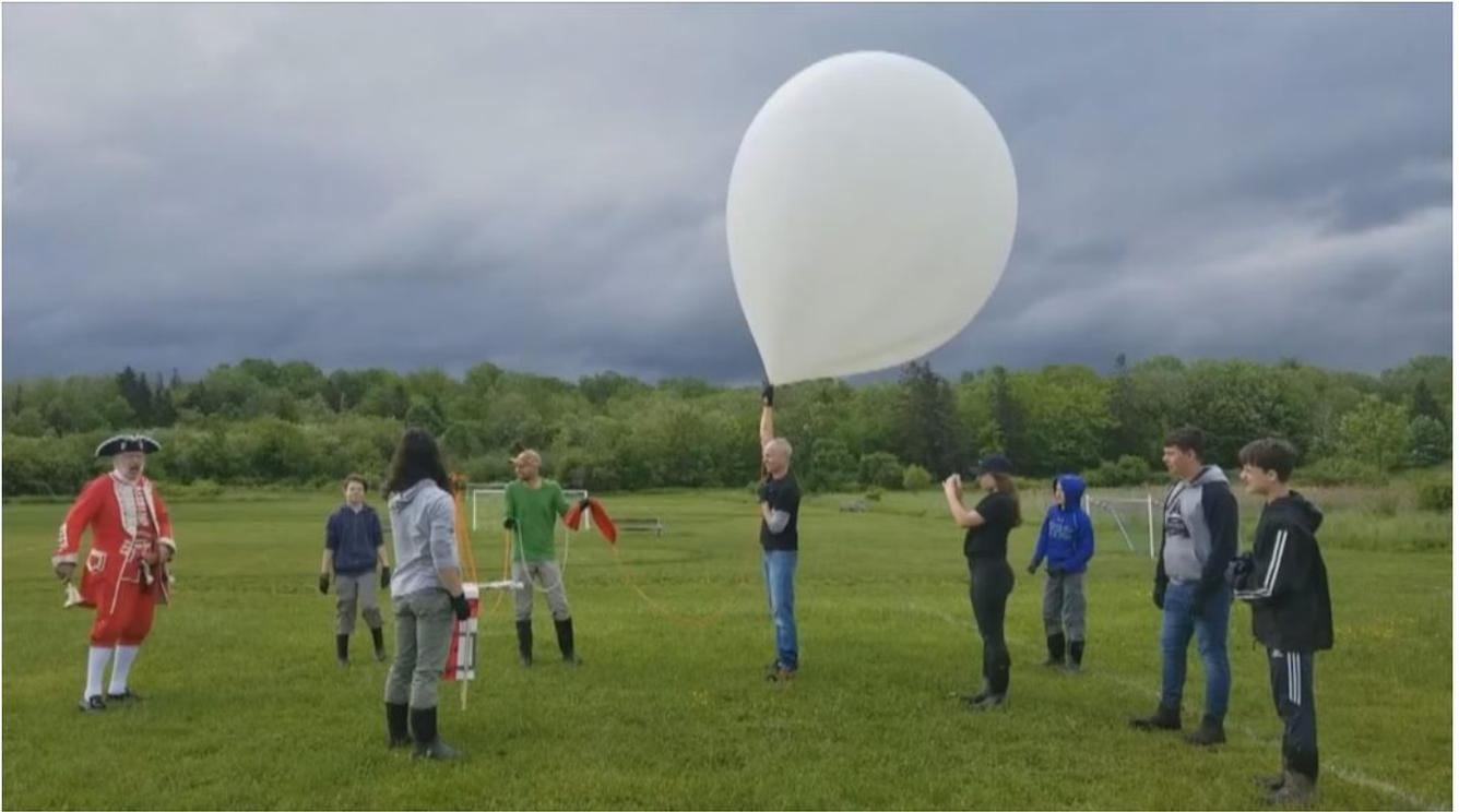
Avant d'être lancés, les ballons Pico ont généralement un diamètre d'environ 1 mètre au sol. Lorsqu'ils montent à des altitudes de 20 000 à 50 000 pieds, l'enveloppe du ballon à haute pression se dilate de 2 à 3 fois et atteint une flottabilité neutre, ce qui leur permet de flotter à une altitude à peu près constante. Les courants de vent les poussent alors à travers l'atmosphère, certains ballons étant capables de faire plusieurs fois le tour du monde avant d'éclater ou de tomber.
