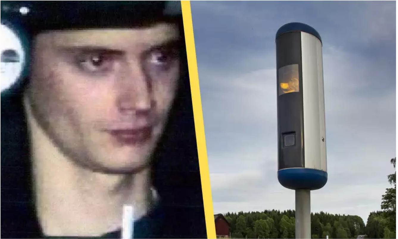
***Des appareils photo reflex numériques sont intégrés dans ces radars destinés au contrôle de la vitesse***
