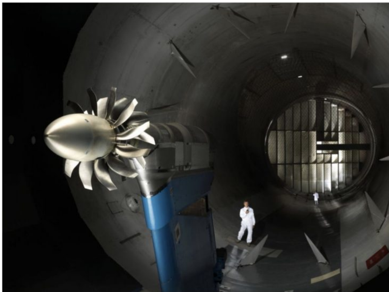
TEST D'UN MOTEUR OPEN ROTOR DE SAFRAN DANS LA SOUFFLERIE ONERA DE MODANE (SAVOIE)
