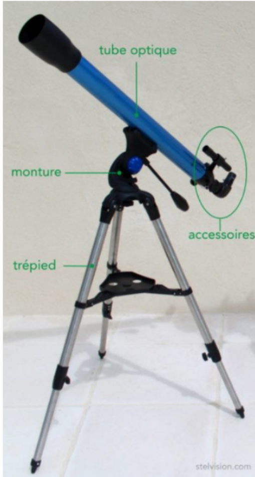
Les constituants d'un instrument d'astronomie. Photo Stelvision.
