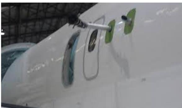
1) Un couple de diffuseurs montés sur un avion de ligne à la place de deux hublots.
