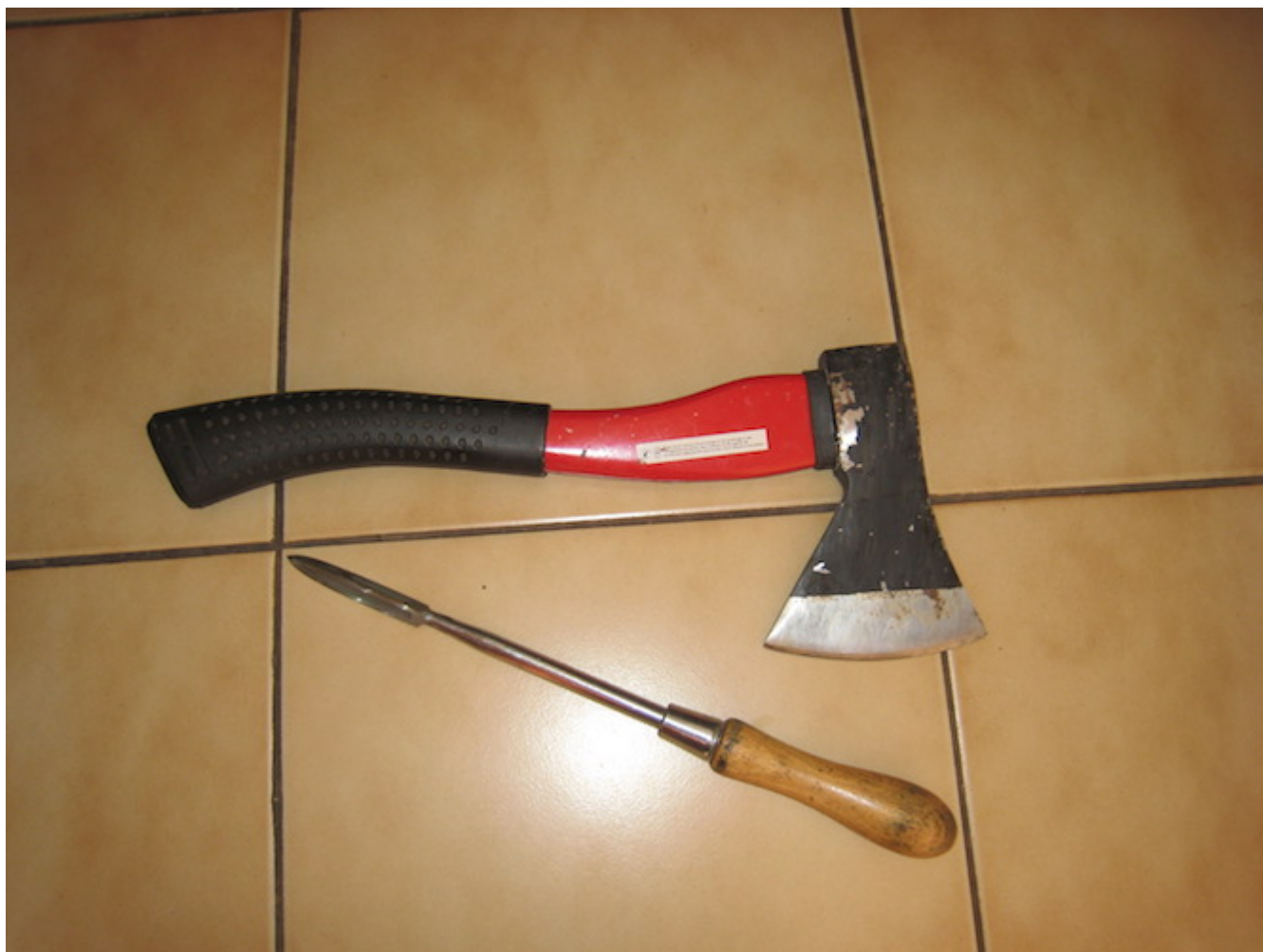
Photo 2 : Le même grattoir et une jolie épée. De section triangulaire aussi, fabriquée avec une ancienne broche de four, laquelle est fixée sur une poignée en vrai bois d'arbre et dont deux rondelles font office de garde et de frein. Réaliser la poignée à sa main.
